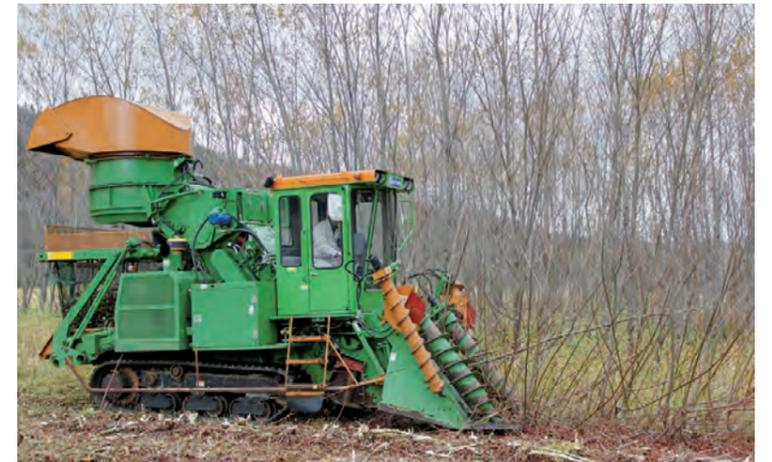
写真1 ケーンハーベスタによるヤナギの収穫風景
