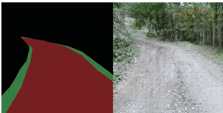
図3 画像生成手法を利用した作業道の画像 左：入力した道の輪郭。 右：生成された作業道画像。
