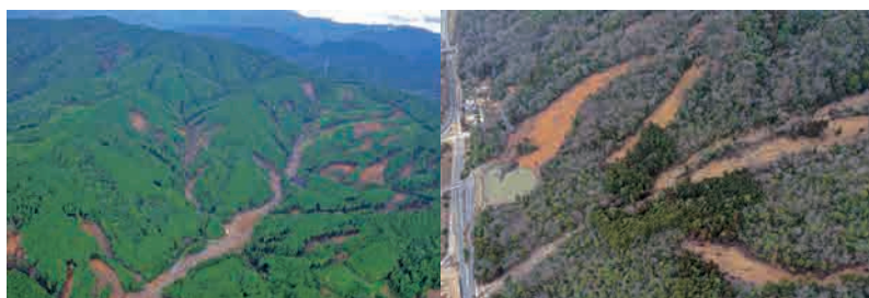
平成29年7月九州北部豪雨(福岡県朝倉市)〈左〉と、平成30年7月豪雨(広島県東広島市)〈右〉で発生した斜面崩壊を上空から撮影した写真。これらの豪雨は、雨の降り方は大きく異なるが、崩壊発生時の雨は共通して100年に一度程度の強さだった。
