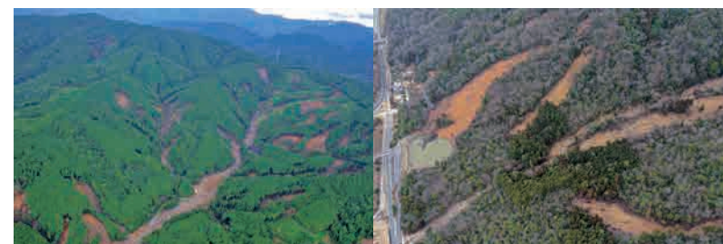
平成29年7月九州北部豪雨(福岡県朝倉市)〈左〉と、平成30年7月豪雨(広島県東広島市)〈右〉で発生した斜面崩壊を上空から撮影した写真。これらの豪雨は、雨の降り方は大きく異なるが、崩壊発生時の雨は共通して100年に一度程度の強さだった。
