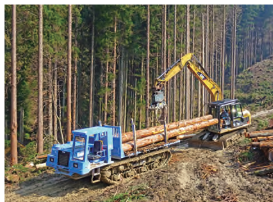
作業道を利用して木材を運搬するため、フォワーダと呼ばれる運搬用の林業機械(左)に木材を積み込んでいるところ。
