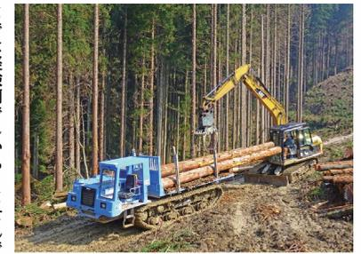
作業道を利用して木材を運搬するため、フォワーダと呼ばれる運搬用の林業機械(左)に木材を積み込んでいるところ。
