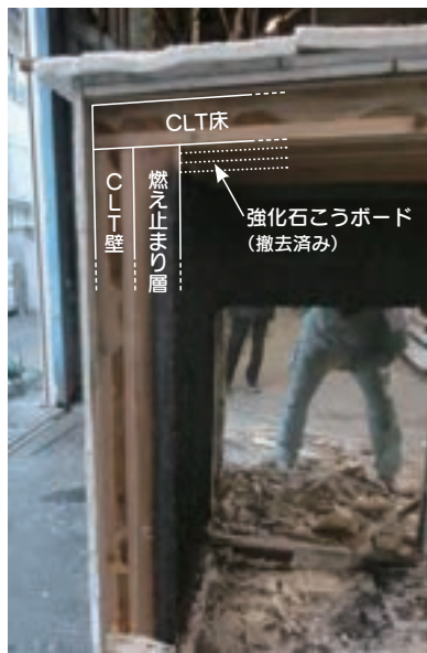
写真3 難燃処理スギパネルで被覆したCLT壁の2時間耐火試験後の様子
