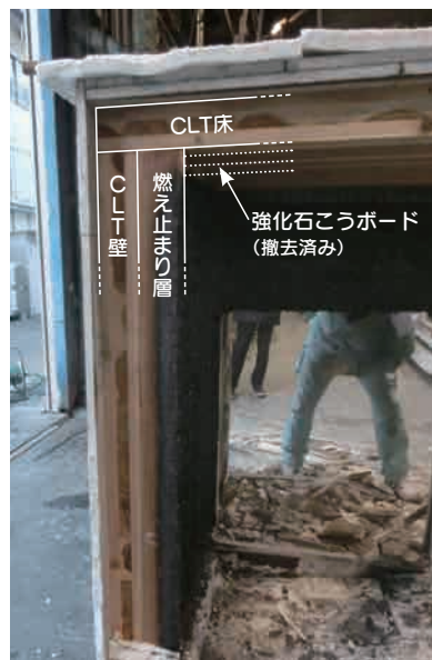
写真3 難燃処理スギパネルで被覆したCLT壁の2時間耐火試験後の様子 CLTの壁に難燃処理スギと無処理表層からなるパネルをネジ留めた試験体(さらに、上部に強化石膏ボード被覆の床、奥に耐火集成材の梁が配置されている)の解体中の様子。画像左側の半分ほど焦げた縦の板状のものがパネルの側面、その左側がCLTの壁。2時間加熱してもCLTは無事だった。
