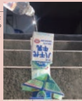
熊谷さんが牛乳パックを使って小学生たちとつくれた転倒ます型雨量計。
