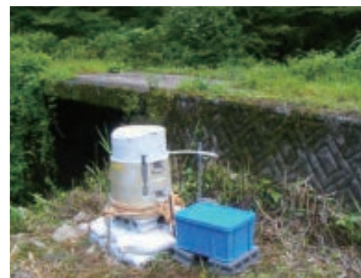
写真3 渓流水の採取方法
