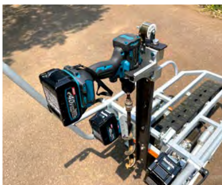
写真3 コンテナ苗植栽用の穴をあける電動オーガ
