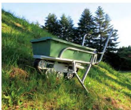
写真2 開発した電動クローラ型1輪車
