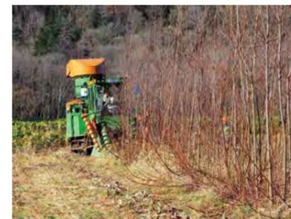
北海道で栽培したヤナギをサトウキビ用収穫機で収穫する様子
