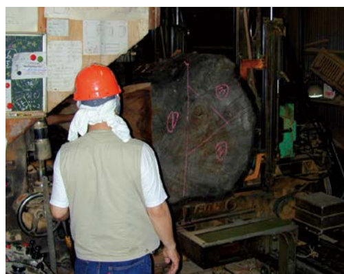
写真2 熟練作業員による木取り 熟練した作業員は、丸太の状態を見て木取りを行い、ノコを入れる位置と順番を決定する。
