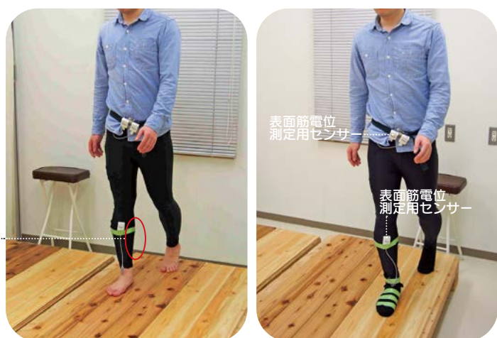
写真3 裸足(左)と靴下履き(右)での歩行時における表面筋電位測定 それぞれの床と対照床を17人の被験者に歩いてもらい、足にとりつけた測定器で、表面筋電位を測定した。歩行は、右足から踏み出して、10歩ほど歩く形でいった。
