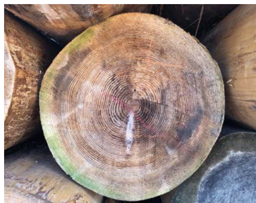
写真1 一般大径材(木口面) 末口径44cm。節があり年輪幅も広く、高品質な製材品の生産には不向きで需要が少ない。
