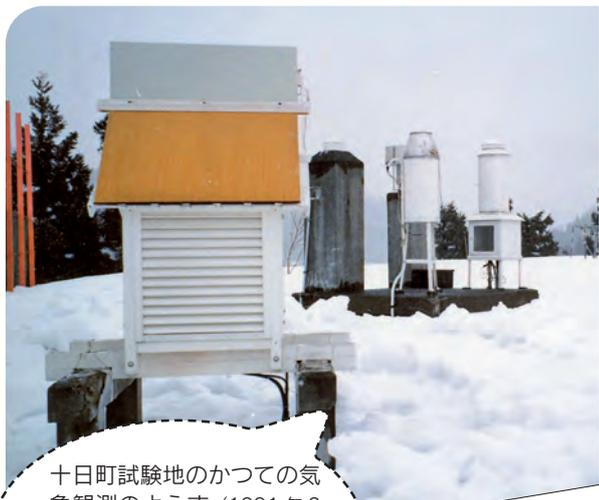
十日町試験地のかつての気象観測のようす（1991年3月撮影）。手前：百葉箱（気温と湿度を測定）奥：降水量を測る装置。
