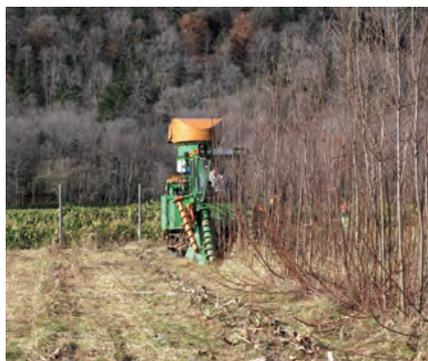
サトウキビ用国産小型収穫機を使ったヤナギ収穫の様子。機械の損傷もなく収穫翌年の再成長も順調だった。作業の効率化が今後の課題。
