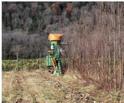
サトウキビ用国産小型収穫機を使ったヤナギ収穫の様子。機械の損傷もなく収穫翌年の再成長も順調だった。作業の効率化が今後の課題。
