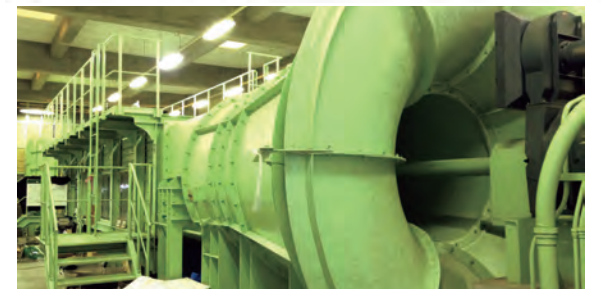
模型実験に使用した風洞装置
