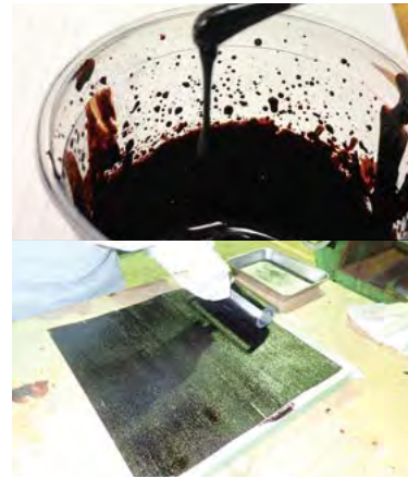
写真2 スギ樹皮フェノール樹脂接着剤(上)と合板製造試験の様子(下) 塗布性(塗りやすさ)も接着剤の重要な性能の一つであり、合板を試作する過程でその確認を行っている様子。
