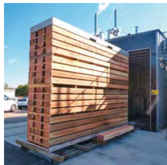
人工乾燥を行うときの木材のようす 所定の寸法に製材した木材を積み上げて乾燥機に入れ、蒸気で加熱して乾燥を行う。
