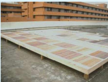
▲エクステリア分野における技術開発(木製デッキの屋上設置による遮熱実験とデッキ塗装の耐候性評価試験)
