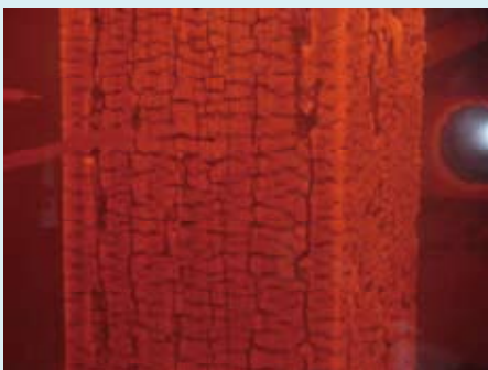
▲耐火材料の技術開発(1時間耐火加熱試験中の耐火集材。加熱終了後、試験体は炉内に放置したままでも自然に炎が消えて燃え止まり、耐火性能のあることが確認されました。)
