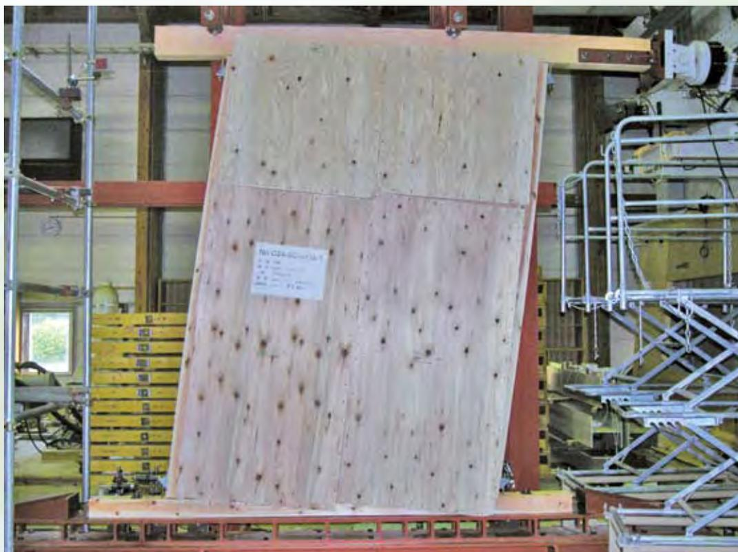
写真3 厚さ24mmの厚物構造用合板を釘留めした壁の強度試験(面内せん断試験)の様子
