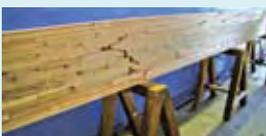
◀集成材の実大引張試験の破断状況
