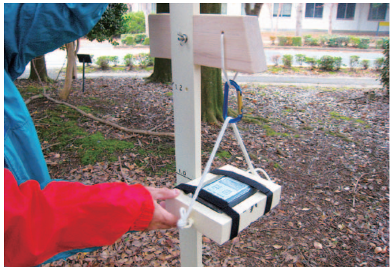
図4 上下方向別空間線量率測定の測定機器と測定の様子。小型線量率計を鉛の遮蔽台にセットし、背面と側面からの放射線を遮断し測定を行う。
