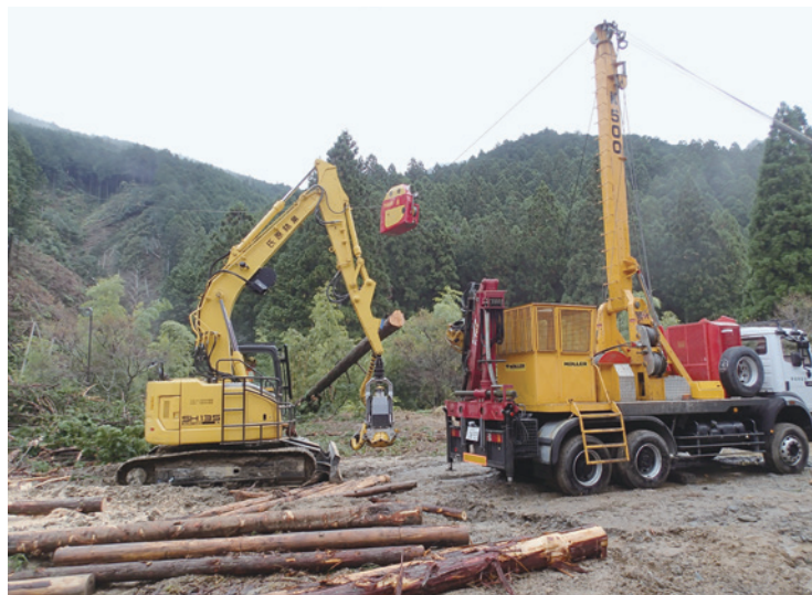
急傾斜地でのタワーヤードを使った搬出作業の効率化
