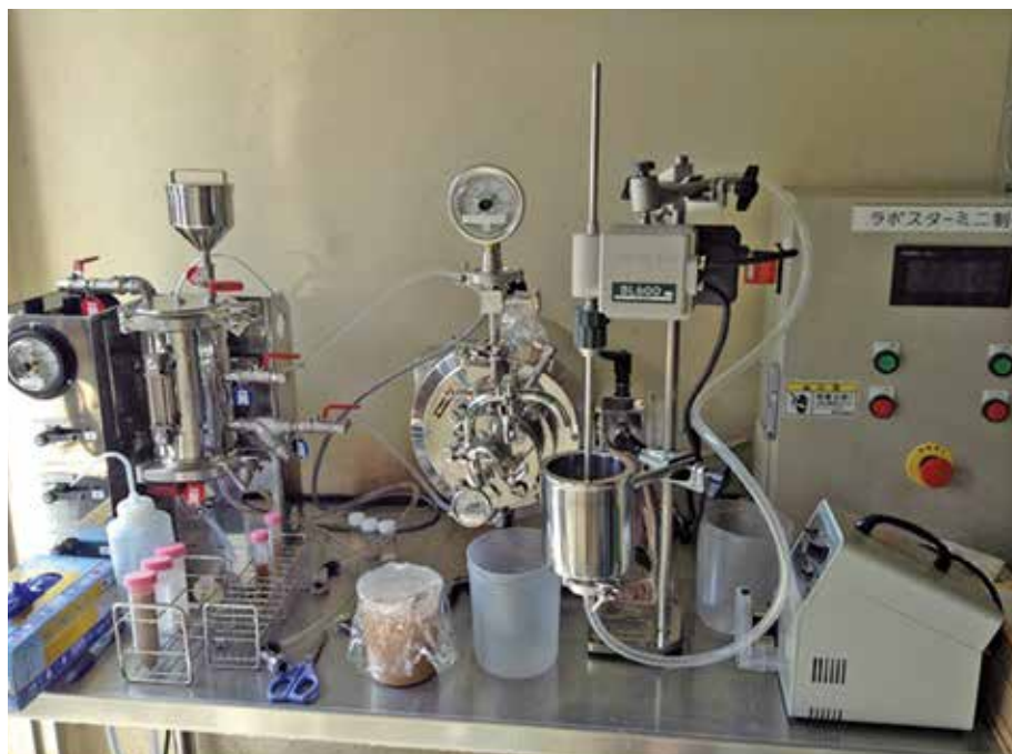
写真3 試作した小型湿式ミリング装置
