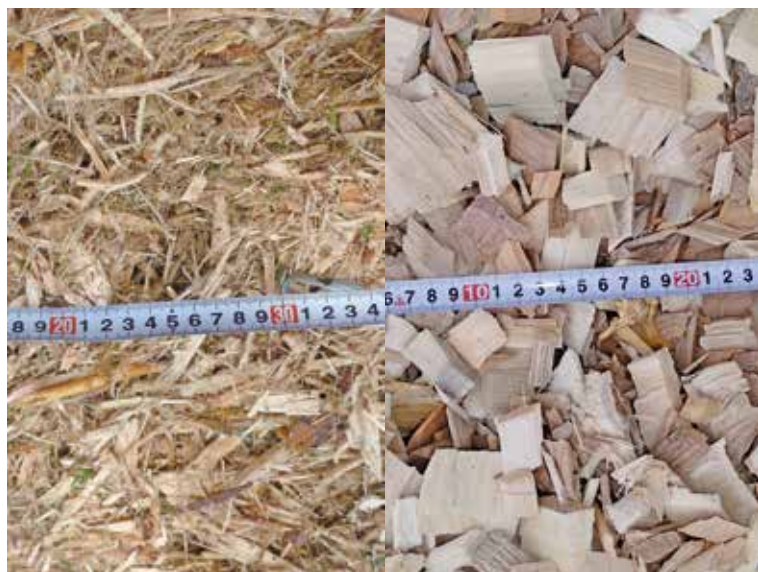
写真2 破碎チップと切削チップ
