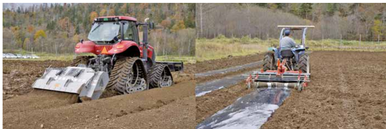
写真2 ストーンクラッシャによる礫岩粉碎とマルチ敷設
