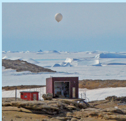
写真6 高層気象観測用ラジオゾンデの放球 1日2回、センサーと発信装置を付けた気球を世界中の観測点で同時刻に放つ（気象庁担当）（2016年1月23日14時30分）。
