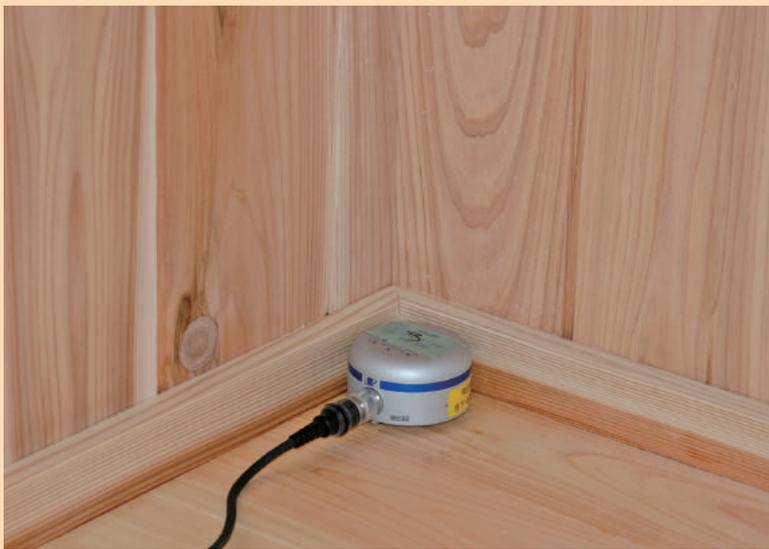
写真2 住宅の内部の床にセンサーを置いて、振動を測定している様子
