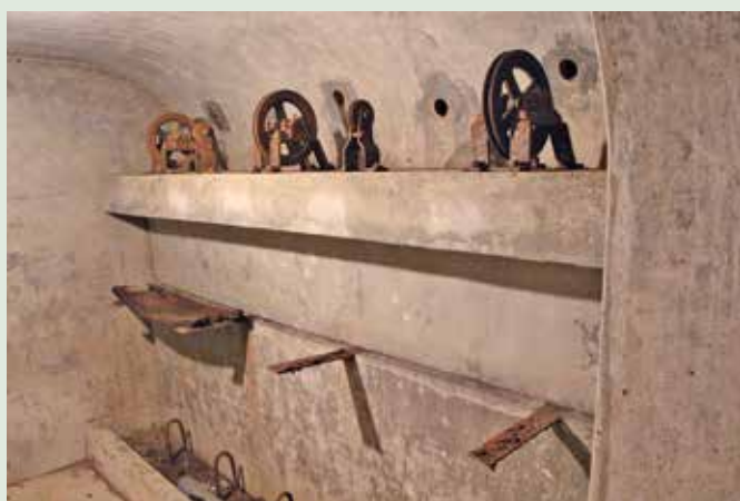
写真3 現在も十日町試験地の地下室に残る実験斜面の積雪移動量計測装置 昭和12年から数年間使われた
