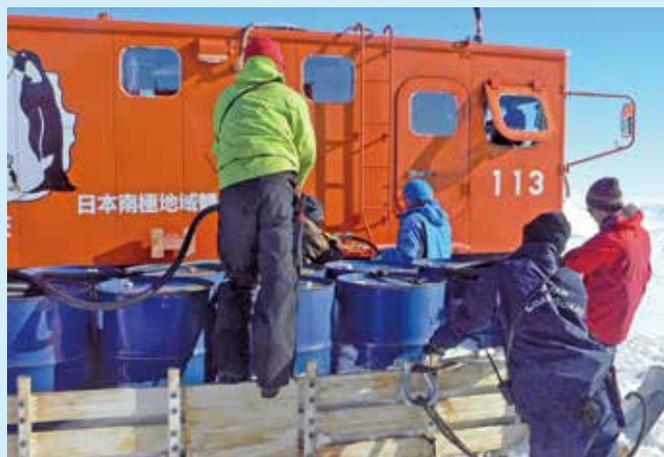
写真3 ドラム缶の燃料を雪上車に給油する様子（2016年1月2日）
