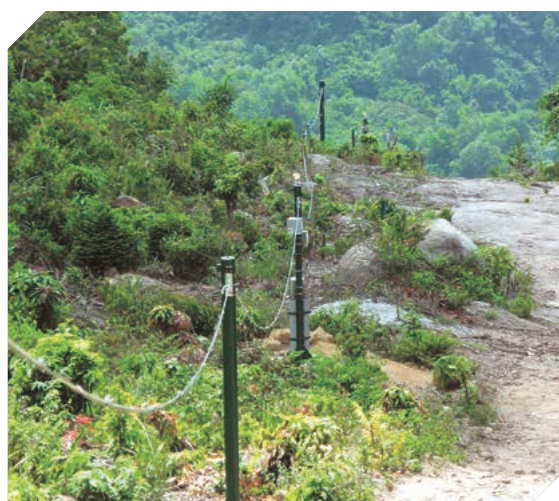
写真3 わずかな地表の変位を測定するセンサー群
