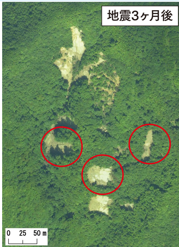
写真1 2008年岩手・宮城内陸地震直後と3ヶ月後に林野庁により撮影された空中写真 赤枠で示した斜面では、地震後の降雨により崩壊が発生していました。
