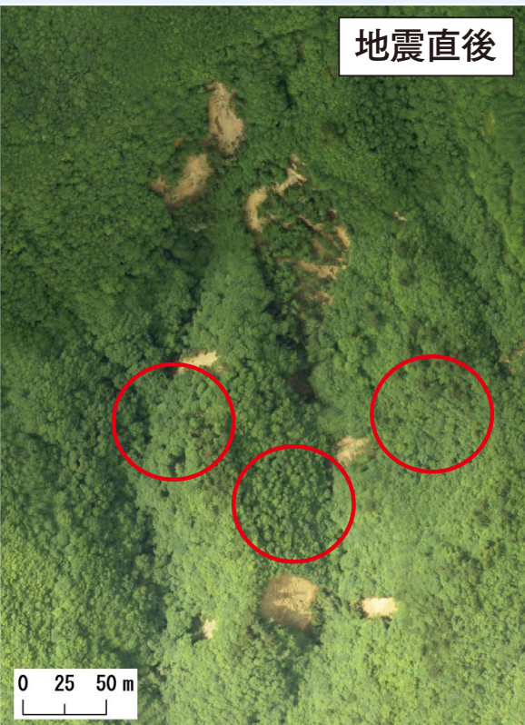
写真1 2008年岩手・宮城内陸地震直後と3ヶ月後に林野庁により撮影された空中写真 赤枠で示した斜面では、地震後の降雨により崩壊が発生していました。
