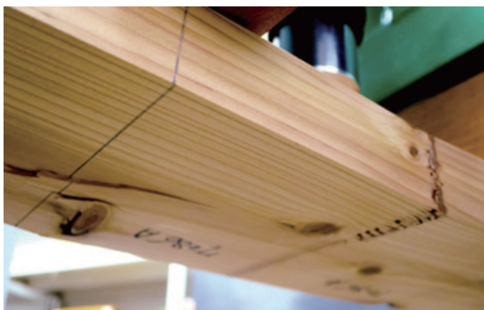
写真2 曲げ試験の様子 左の写像是、破壊の様子。フィンガージョイントでの破壊（木材の右側）と節での破壊（木材の左側）が生じたことがわかる。右の写像是、試験時の様子。上部の2か所から加力して強度を測定する。フィンガージョイント部を加力点間の中央に配置して実験を行った。
