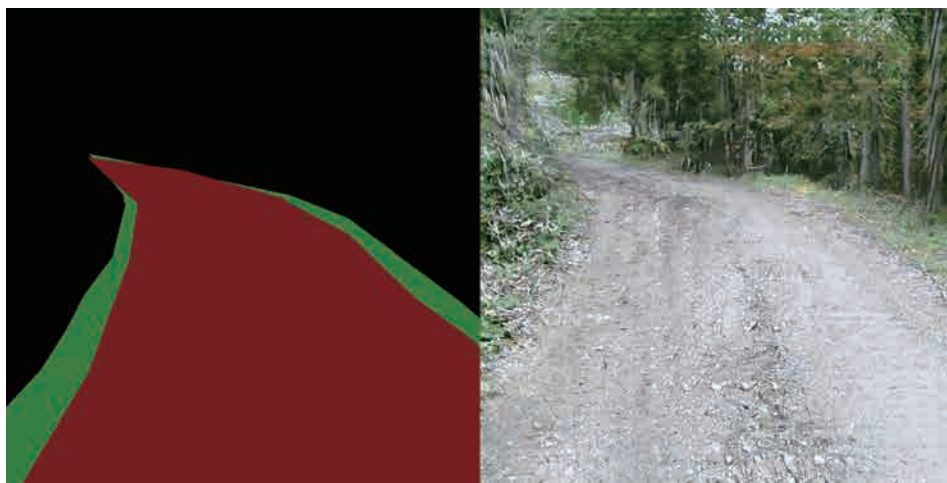
図3 画像生成手法を利用した作業道の画像 左：入力した道の輪郭。 右：生成された作業道画像。
