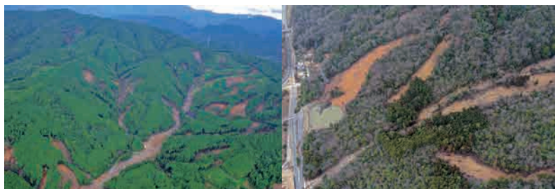
平成29年7月九州北部豪雨(福岡県朝倉市)〈左〉と、平成30年7月豪雨(広島県東広島市)〈右〉で発生した斜面崩壊を上空から撮影した写真。これらの豪雨は、雨の降り方は大きく異なるが、崩壊発生時の雨は共通して100年に一度程度の強さだった。
