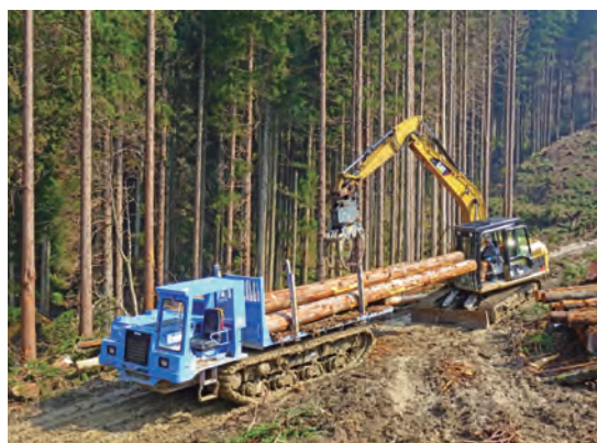
作業道を利用して木材を運搬するため、フォワードと呼ばれる運搬用の林業機械(左)に木材を積み込んでいるところ。
