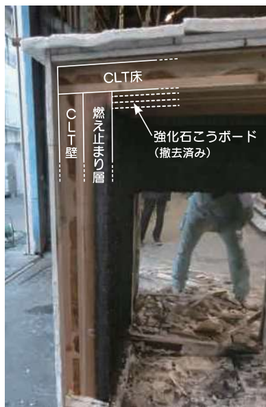
写真3 難燃処理スギパネルで被覆したCLT壁の2時間耐火試験後の様子
