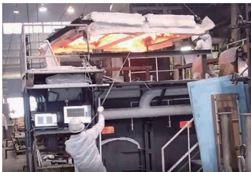
写真4 超厚合板(床)の準耐火試験(90分加熱後の脱炉時)
