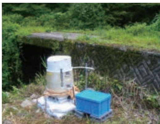
写真3 渓流水の採取方法
