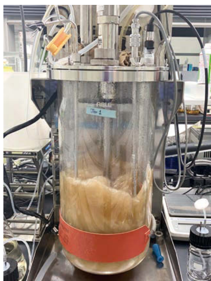
写真1 PDC生産微生物の培養槽
