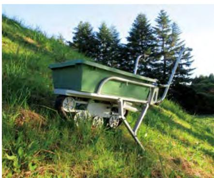
写真2 開発した電動クローラ型1輪車
