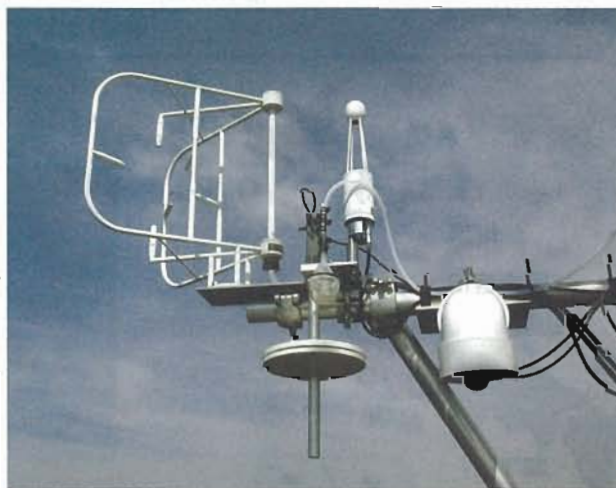
図4. タワー頂部に設置した乱流変動法の測器群（測定要素：風速の3次元成分，気圧，CO 2 濃度，水蒸気濃度など）
