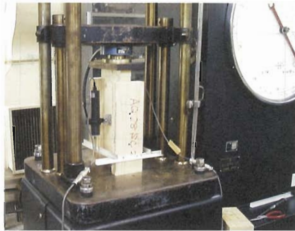
写真3. 厚物構造用合板の釘接合せん断試験
