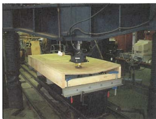
写真6. 床構造の局部荷重に対する耐力評価試験 （約1トンの荷重が加わった状態）
