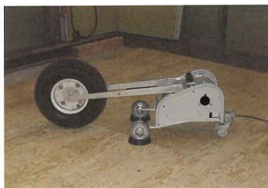
写真5. 床構造の遮音性能評価試験 （ボラス暮らし科学研究所にて）
