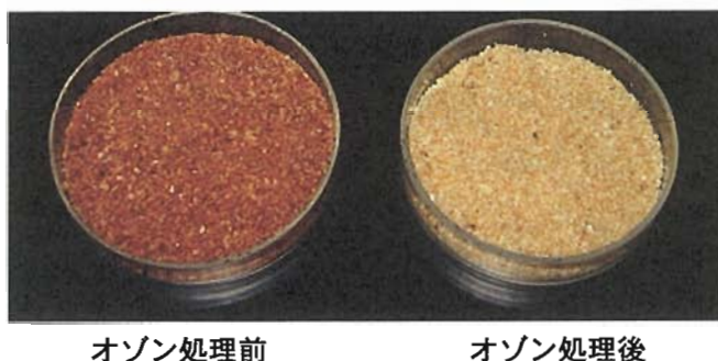
図5. オゾン処理によるスギ木粉中のリグニンの分解
