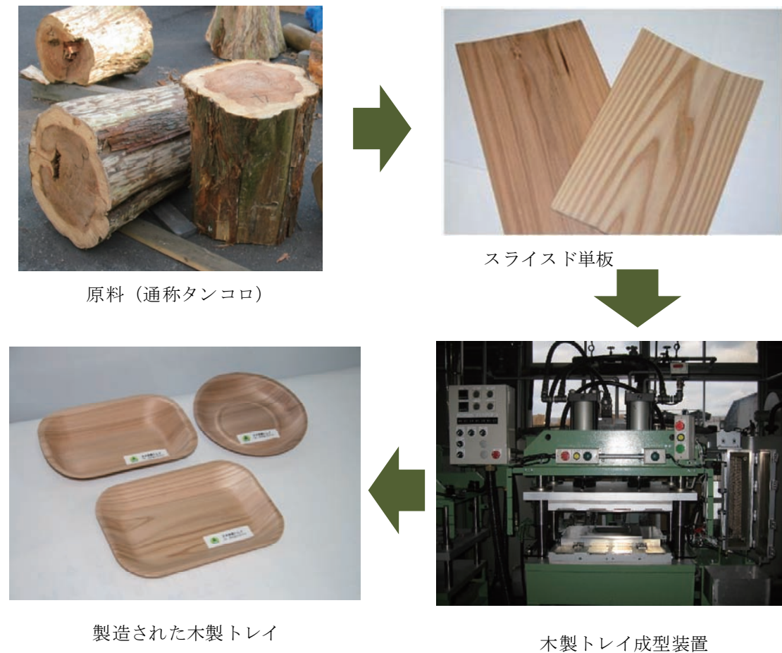
図 2. トレイの原料、単板、成型装置と製造された木製単層トレイ
