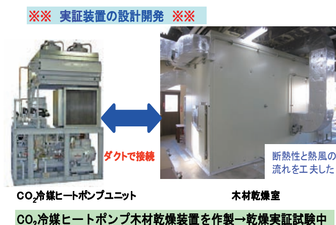
図 5 各試算を基に作製した CO 2 冷媒ヒートポンプを応用した検証試験用乾燥装置
