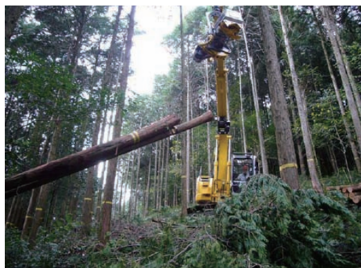
図 3 高性能林業機械の一つ、ウィンチ付きハーベスタ。これ一台で伐採木の引き寄せ、玉切り等の複数の作業が出来る。
