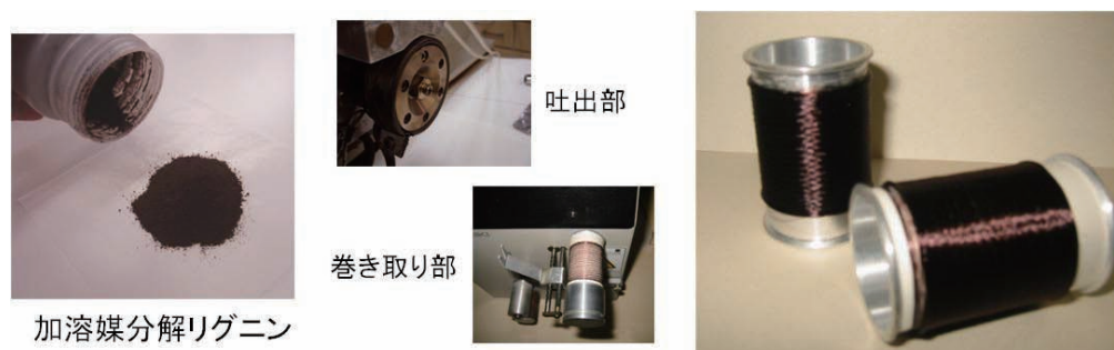
図 3 炭素繊維製造のためのスギ加溶媒分解リグニンの熔融紡糸
