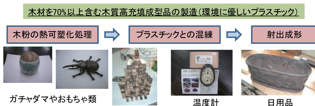
図 6 木質高充填複合プラスチックによる石油系プラスチックの代替
