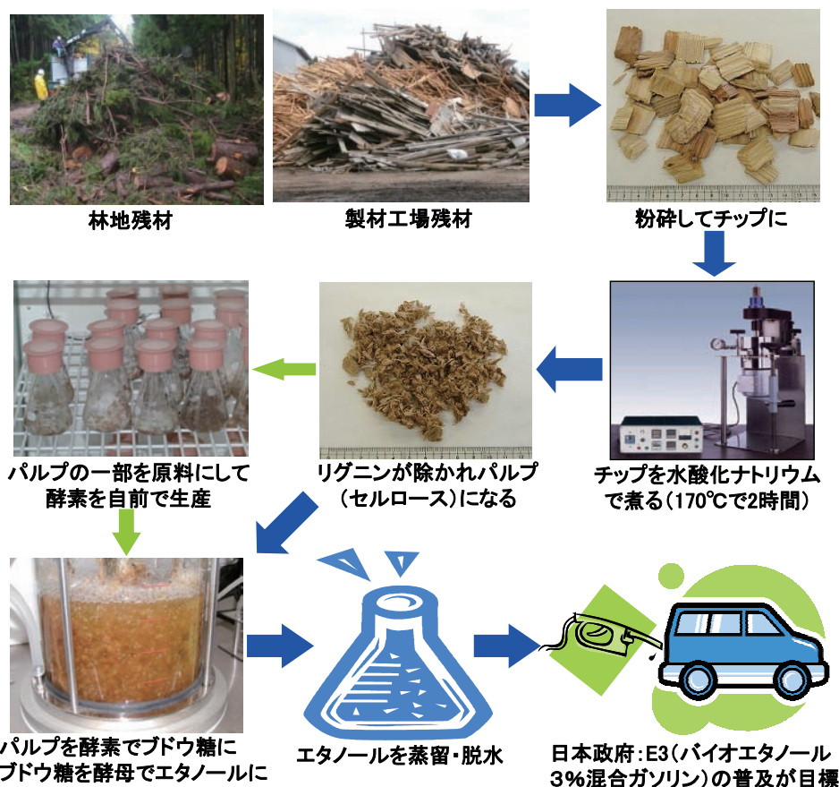
図2 アルカリ蒸解酵素糖化法によるバイオエタノール製造工程フロー
