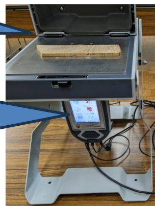
図3 木材のカリウム濃度を測定している様子
