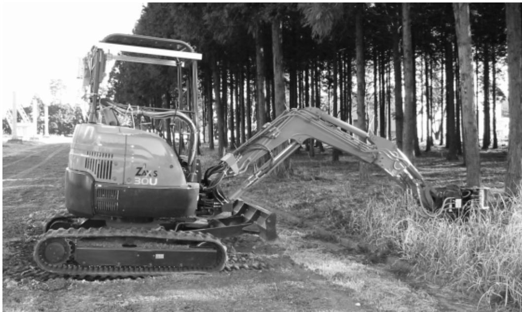
図 2-2-3 遠隔制御による立木把持操作実験
