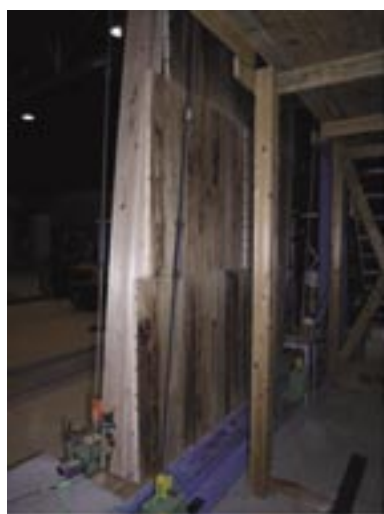
写真 1-3-3 スギ圧密パネルを張った床の面内せん断試験の様子
