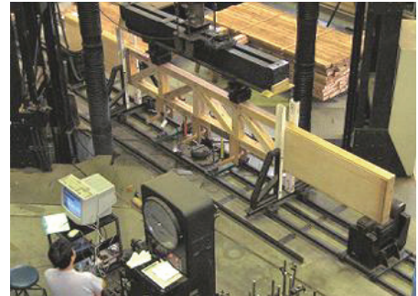
図 1-1-7 合板で補強された平行弦トラス試験体
