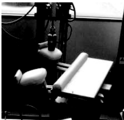
写真 2-2-5 ひじ部への垂直力試験
