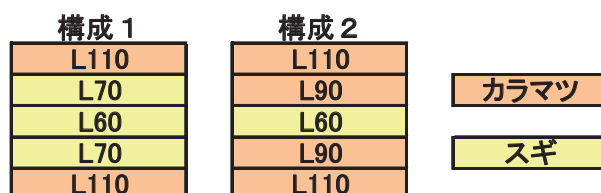
図 2-4-2 集成材のラミナ構成（むり込み、せん断試験）
