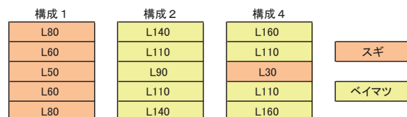
図 2-1-3 集成材のラミナ構成（せん断試験体）
