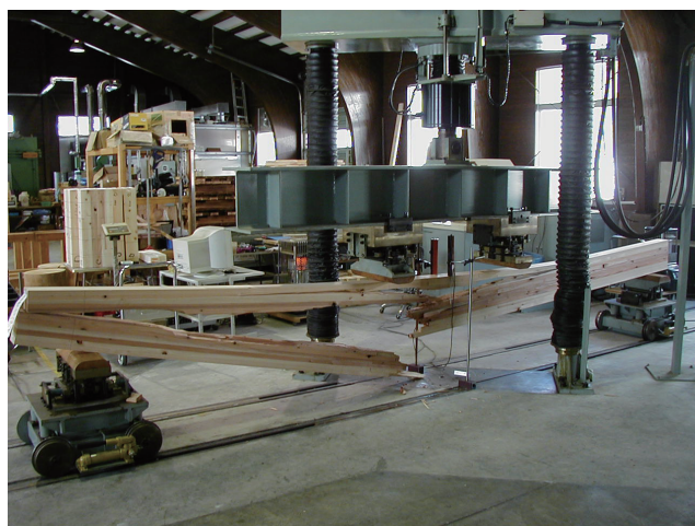
図 2-5-7 曲げ破壊形態
