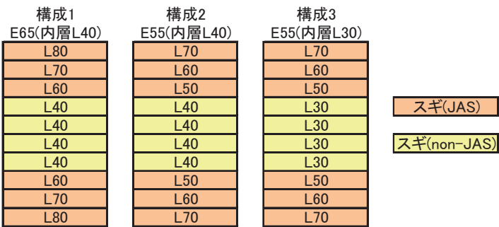
図1-1-1 集成材ラミナの構成(曲げ、縦圧縮、縦引張り試験)
