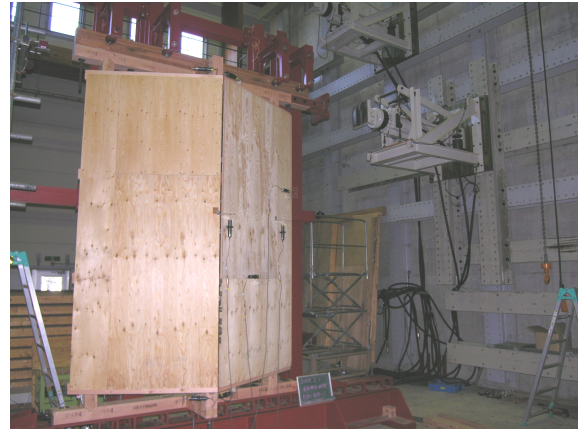
図 8-5 屋根構面の静的水平せん断試験の様子
