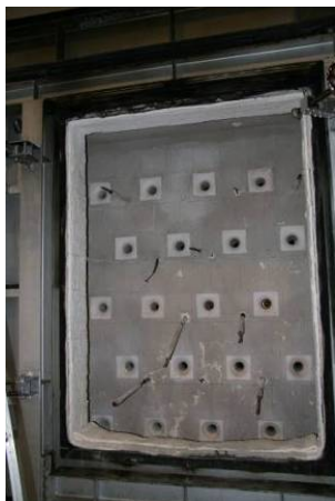
写真 6-3-1 加熱試験用壁型炉
