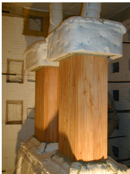
図 7-1 耐火加熱試験の試験体設置状況
