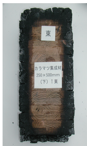
図 7-9 カラマツ集成材 (No.5)の断面 12)
