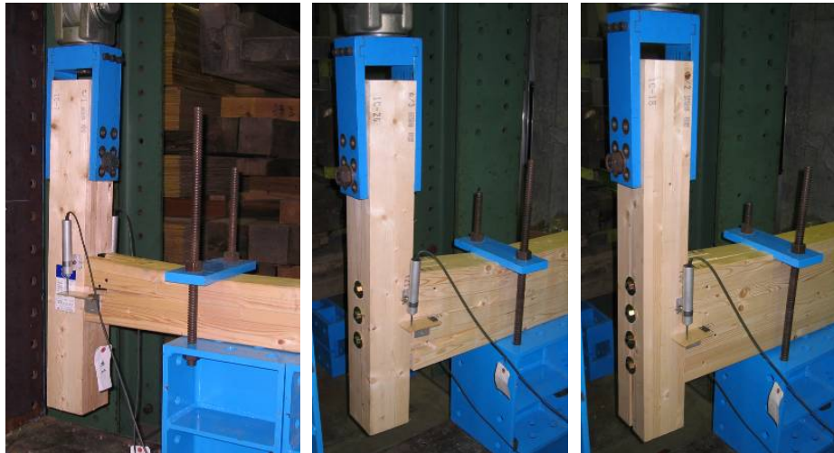
図 4-12 試験法比較実験ト型試験体の破壊状況(左から梁せい 150/240/300mm)
