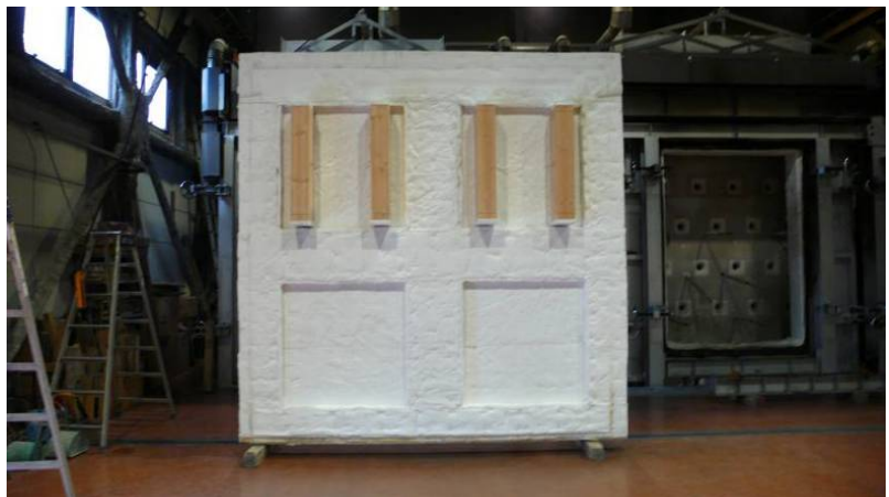
写真 6-3-2 試作した試験体設置用枠
