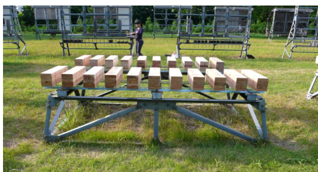
写真 6-2-1 屋外暴露試験体設置状況（南面）
