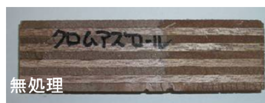
図 3-7 銅系薬剤（ACQ-p, CUAZ-p）の呈色および浸潤度比較
