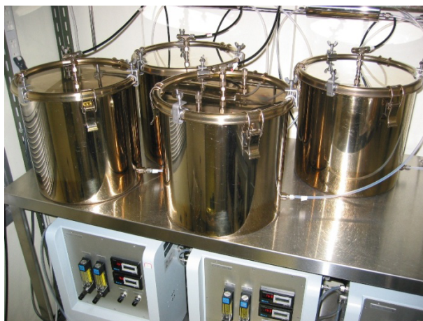
図 4-2 小形チャンバー法の様子
