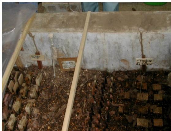
図 3-3 ファンガスセラー（腐朽槽）の様子 （森林総合研究所内）
