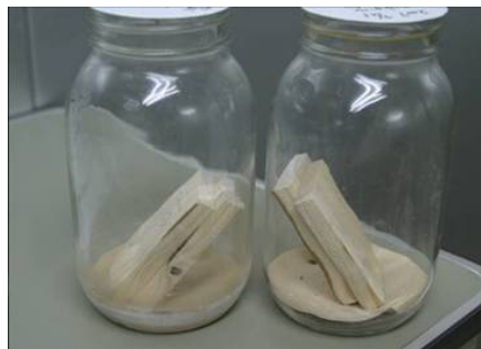
図 3-6 防虫試験(成虫試験)の様子
