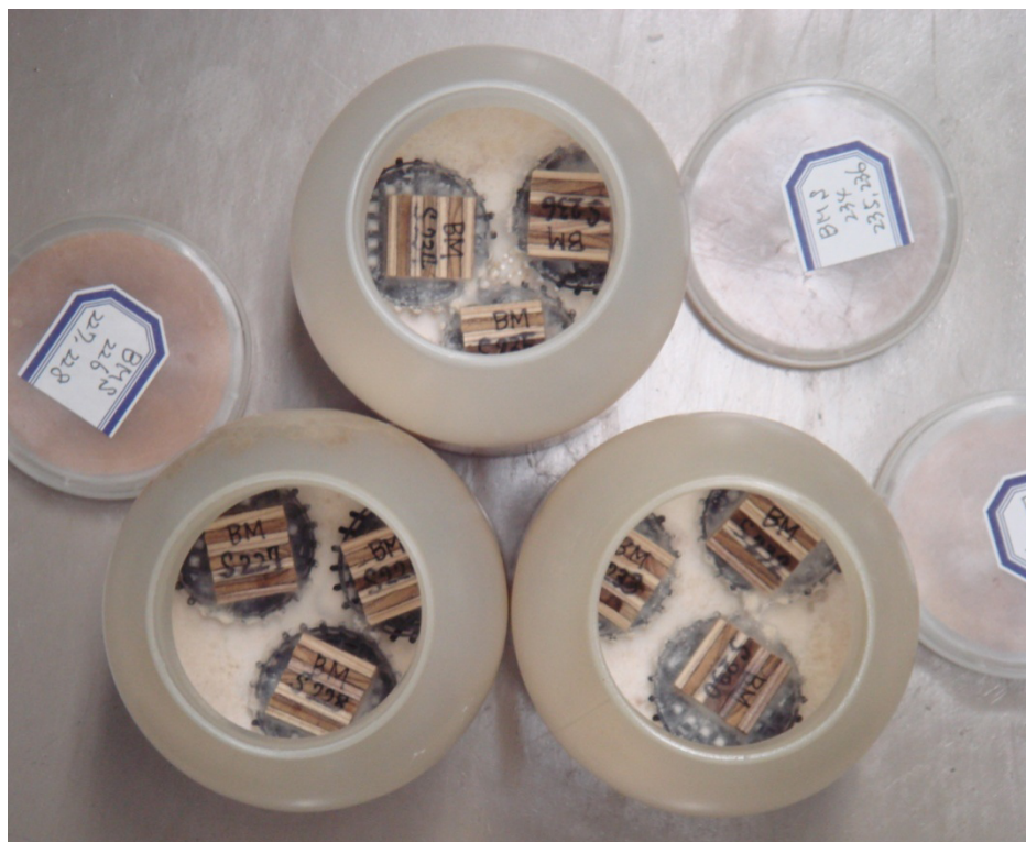
図 3-2 室内防腐試験の様子
