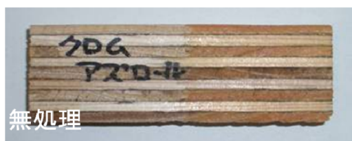
図 3-7 銅系薬剤（ACQ-p, CUAZ-p）の呈色および浸潤度比較
