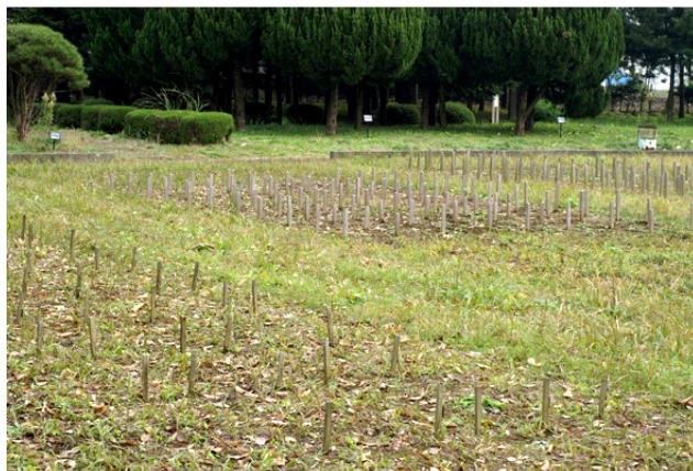
図 3-4 野外防腐試験の様子 （茨城県つくば市森林総合研究所暴露場）
