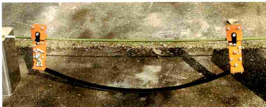
図 3-2 ストッパー型搬器検知装置
