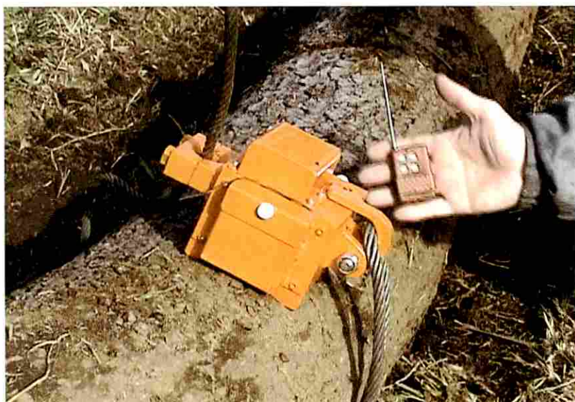
図 3-3 無線操作式チョークアップ装置
