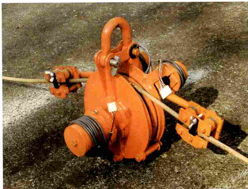
図 3-1 スナッチブロック型検出装置
