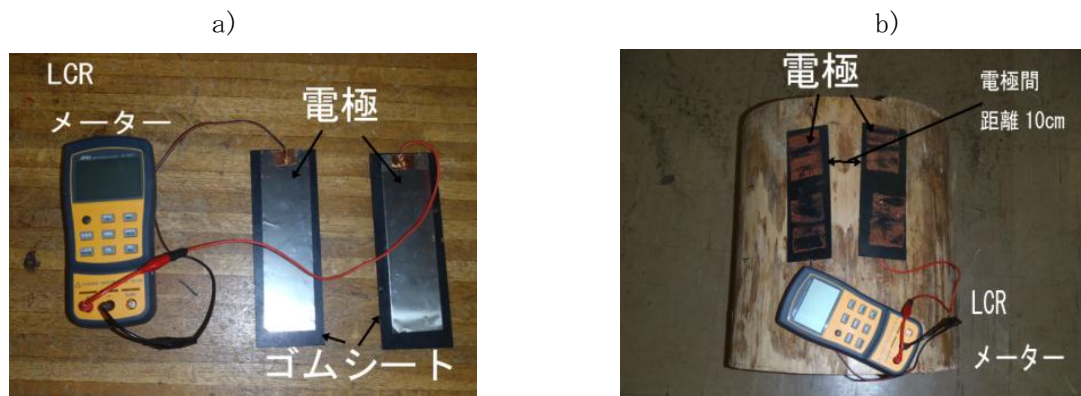
図 1-2-2 押し当て電極による方法
