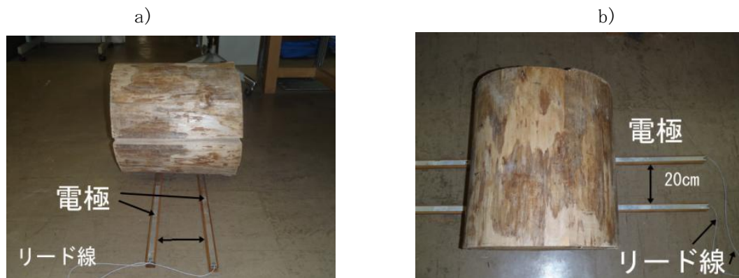
図 1-2-3 アルミアンテナ電極と丸太への配置例
